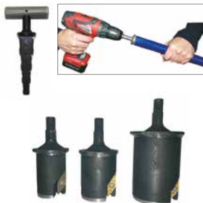
Calibra el diámetro interior del tubo y rebaba la arista para que al montar el accesorio no dañe la junta.
